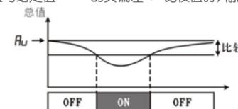
HLPS 表示 总值与给定值 Au 的偏差绝对值 > 比较值时, 输出导通
