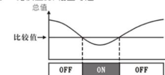
HP-S 表示总值与给定值 Au 的正偏差 > 比较值时, 输出导通
